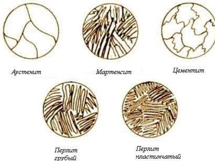
Рисунок 1 – Изменение структуры металла при термической обработке
