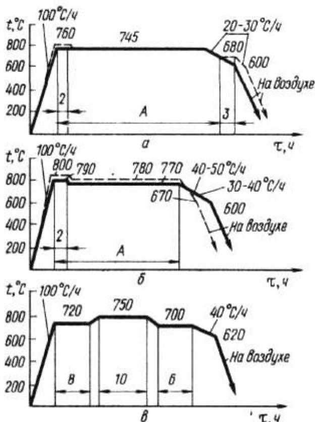
Рисунок 8 – Режимы отжига сортового проката углеродистых инструментальных сталей: *a* – У7, У8, У9; *б* – У10, У11, У12, У13; *в* – «исправительный отжиг сталей У7-У13(масса садки 30 тонн); сплошная линия – профили диаметром до 40 мм; штриховая – диаметром более 40 мм
