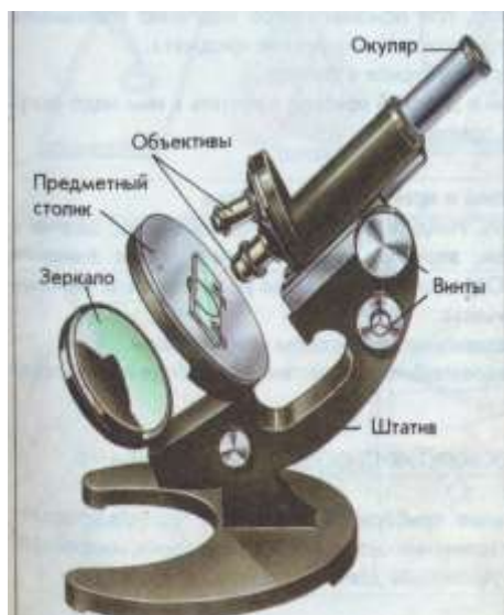
Рис. 1. Строение светового микроскопа
