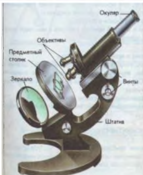
Рис. 1. Строение светового микроскопа
