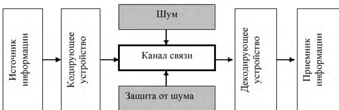
Рисунок 2 Схема процесса передачи информации по техническим каналам связи
