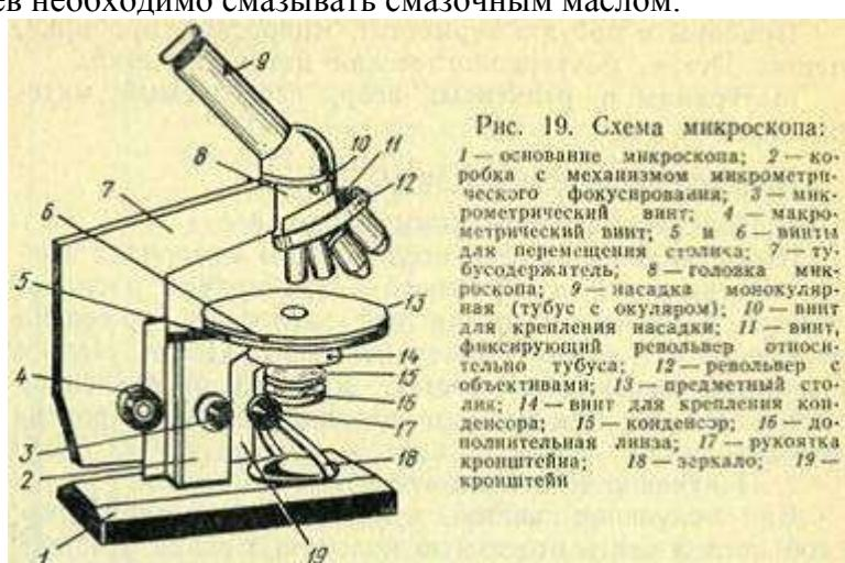
Рис. 19. Схема микроскопа:
