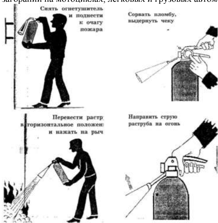
Рис. 3. Приведение в действие ручного углекислого огнетушителя.
