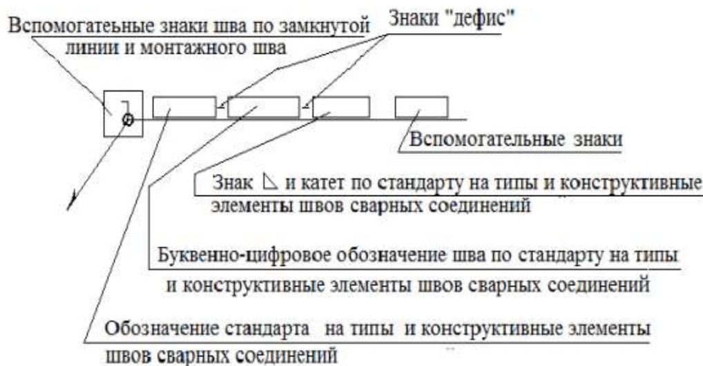
Рис.101 Схема условного обозначения стандартных сварных швов
