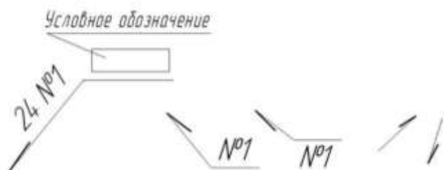
Рисунок 102 – Условные обозначения при наличии на чертеже одинаковых швов: а) у одного изображения; б) у остальных изображений; в) упрощенные или все швы на чертеже одинаковые
