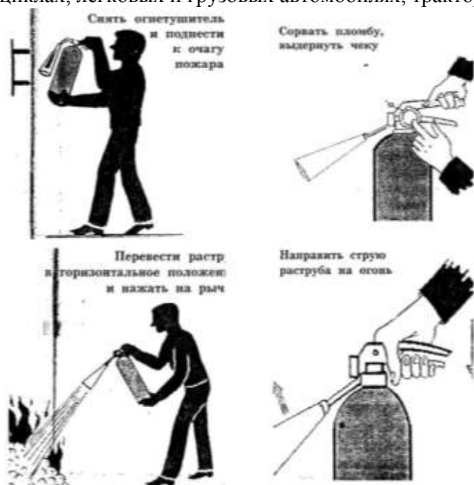
Рис. 3. Приведение в действие ручного углекислого огнетушителя.
