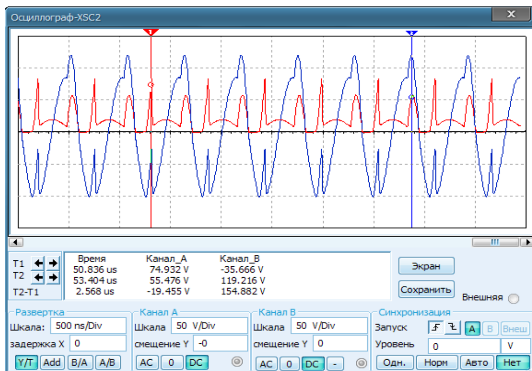
Рис. 2 - Осциллограмма усилительного каскада с 1 LC цепочкой.
