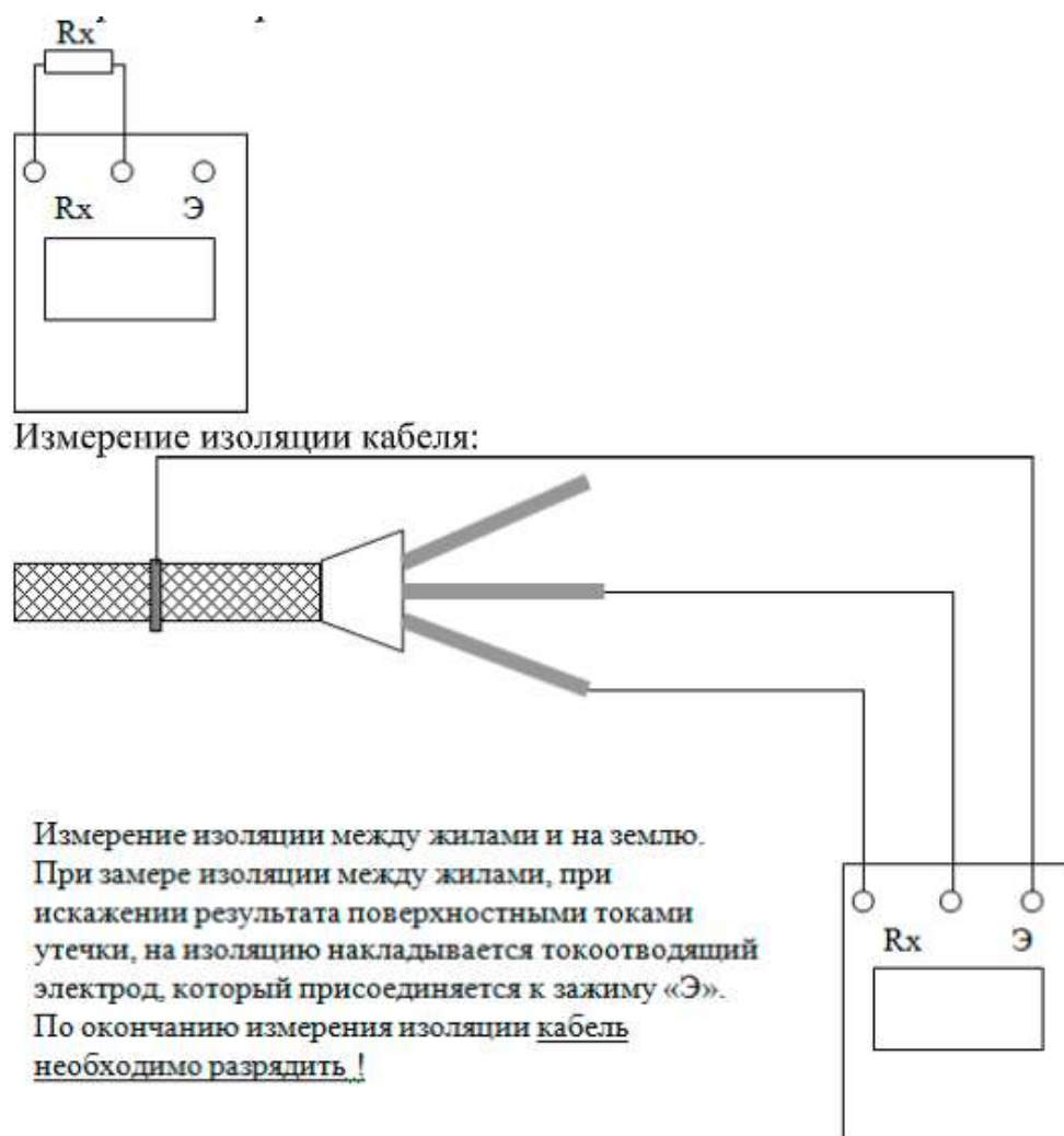
Рисунок 1 - Схема проверки изоляции мегомметром. Измерение сопротивления
