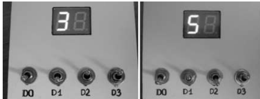
Рисунок 11 – Демонстрация работы семисегментного индикатора
