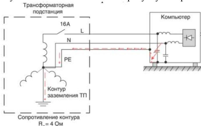
Рис.1. Система заземления СВТ.
