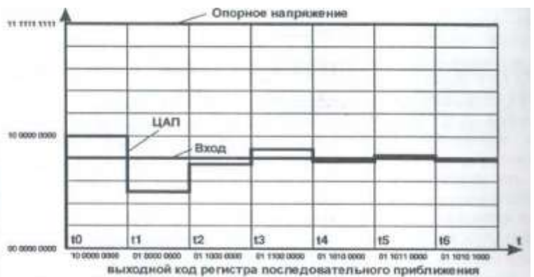
Рис. 2. Принцип работы АЦП последовательного приближения
