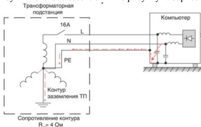
Рис.1. Система заземления СВТ.
