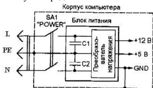
Рис. 2. Типовая схема подключения СВТ к питающей сети.
