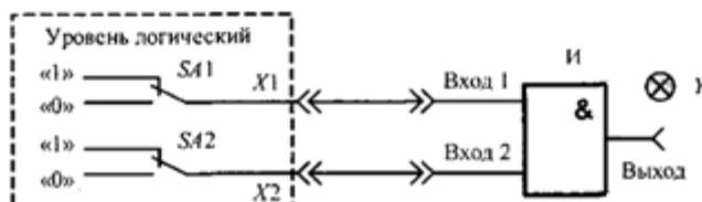
Рис. 1. Схема соединений для исследования логического элемента И
