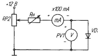
3. Снять обратную ветвь ВАХ выпрямительного диода
