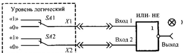
Рис. 1. Схема соединений для исследования логического элемента ИЛИ-НЕ
