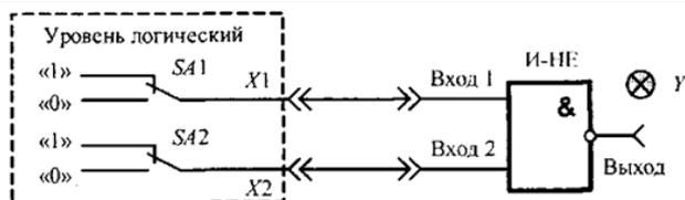
Рис. 1. Схема соединений для исследования логического элемента И-НЕ
