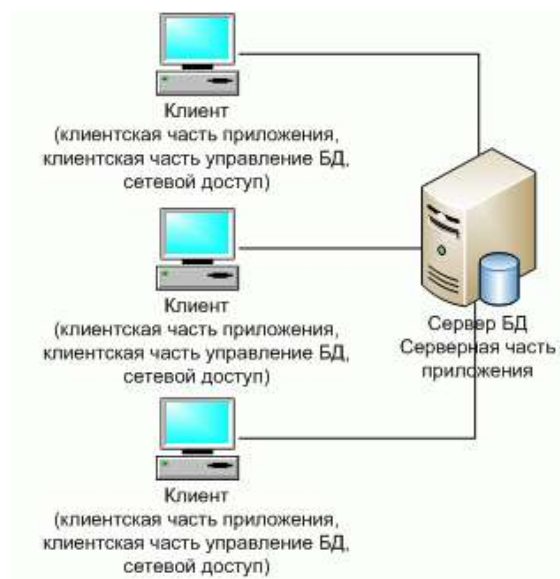
Рис. 3. Классическое представление архитектуры "клиент-сервер"
