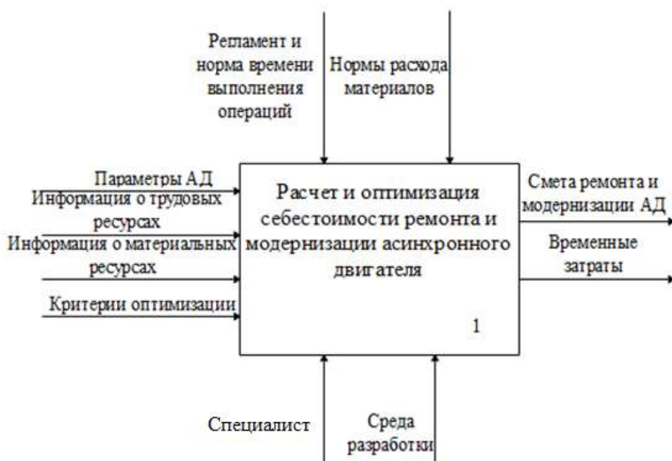
Рисунок 1 – Функциональная модель бизнес-процесса расчета и оптимизации себестоимости ремонта и модернизации асинхронного двигателя
