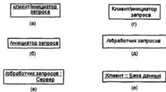
Рис. 4. Примеры различных вариантов записи имен объектов, ролей и классов на диаграммах кооперации
