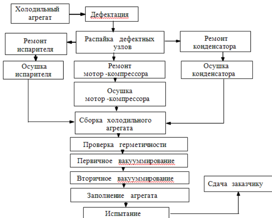
Рис. 1 Технологическая схема ремонта компрессионного холодильного агрегата
