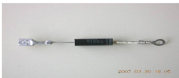
Рис. 3 Высоковольтный диод СВЧ печи
