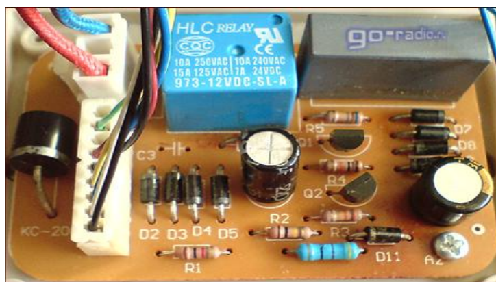
Рис. 4 Основная электронная плата термopота
