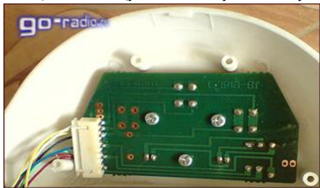
Рис 5. Плата управления и индикации
