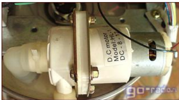
Рис.3 Двигатель водяной помпы
