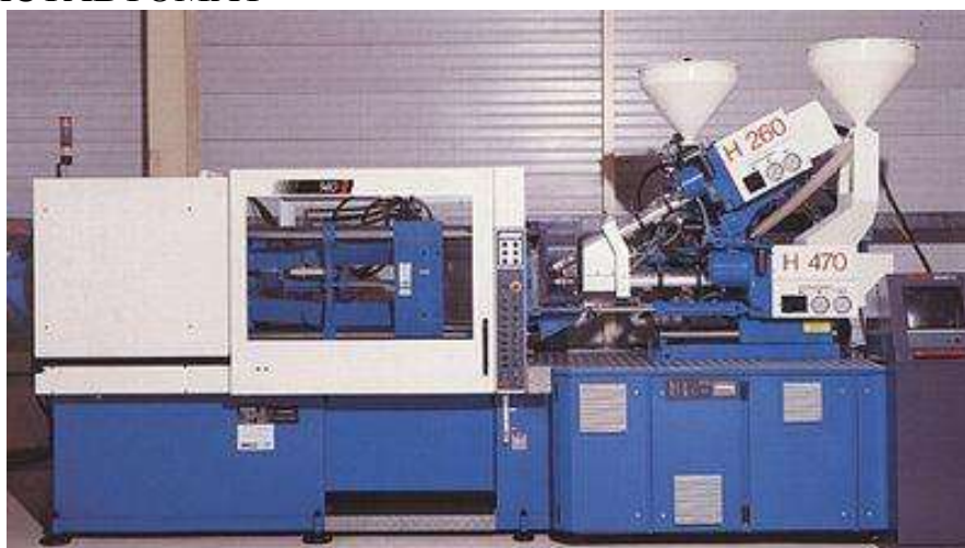
Рисунок 5.1 – Двухкомпонентный горизонтальный термопластавтомат
