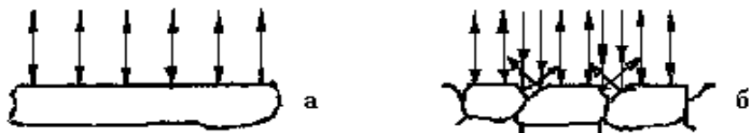
Рис. 2. Схема отражения световых лучей от поверхности полированного (а) и подвергнутого травлению (б) микрошлифа.
