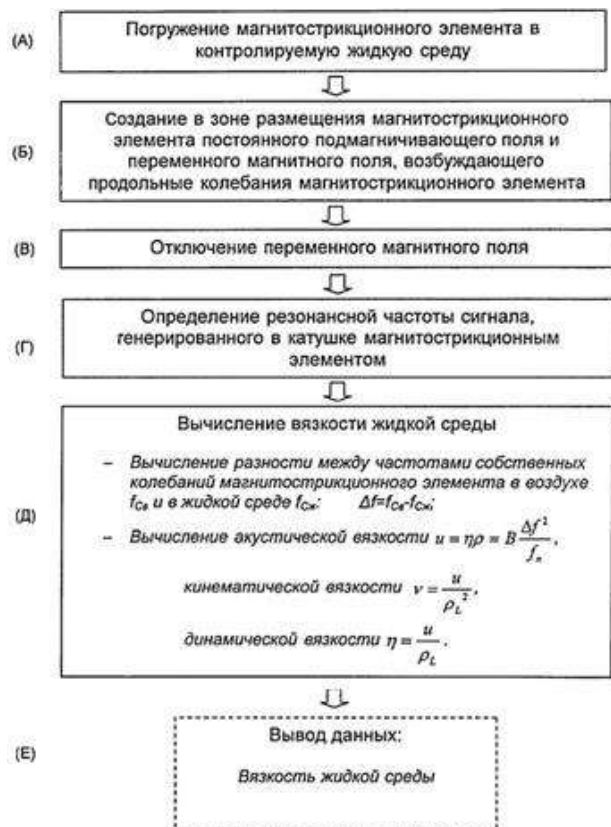
Рисунок 3 - Последовательность выполнения операций измерения вязкости.
