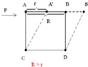
**Пластическая (остаточная) деформация** – если после удаления внешних сил тело не восстанавливает полностью первоначальную форму и размеры. Пластическая (остаточная) деформация металла является следствием сдвигов, происходящих внутри и по границам, через *механизмы пластической деформации*.
