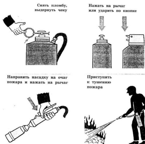
Рис.1. Приведение в действие воздушно-пенного огнетушителя.
