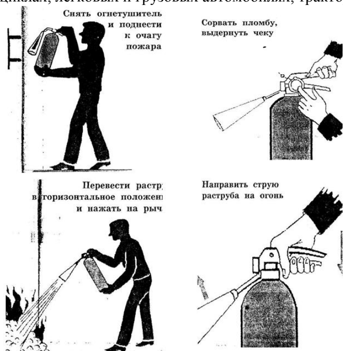
Рис. 3. Приведение в действие ручного углекислого огнетушителя.
