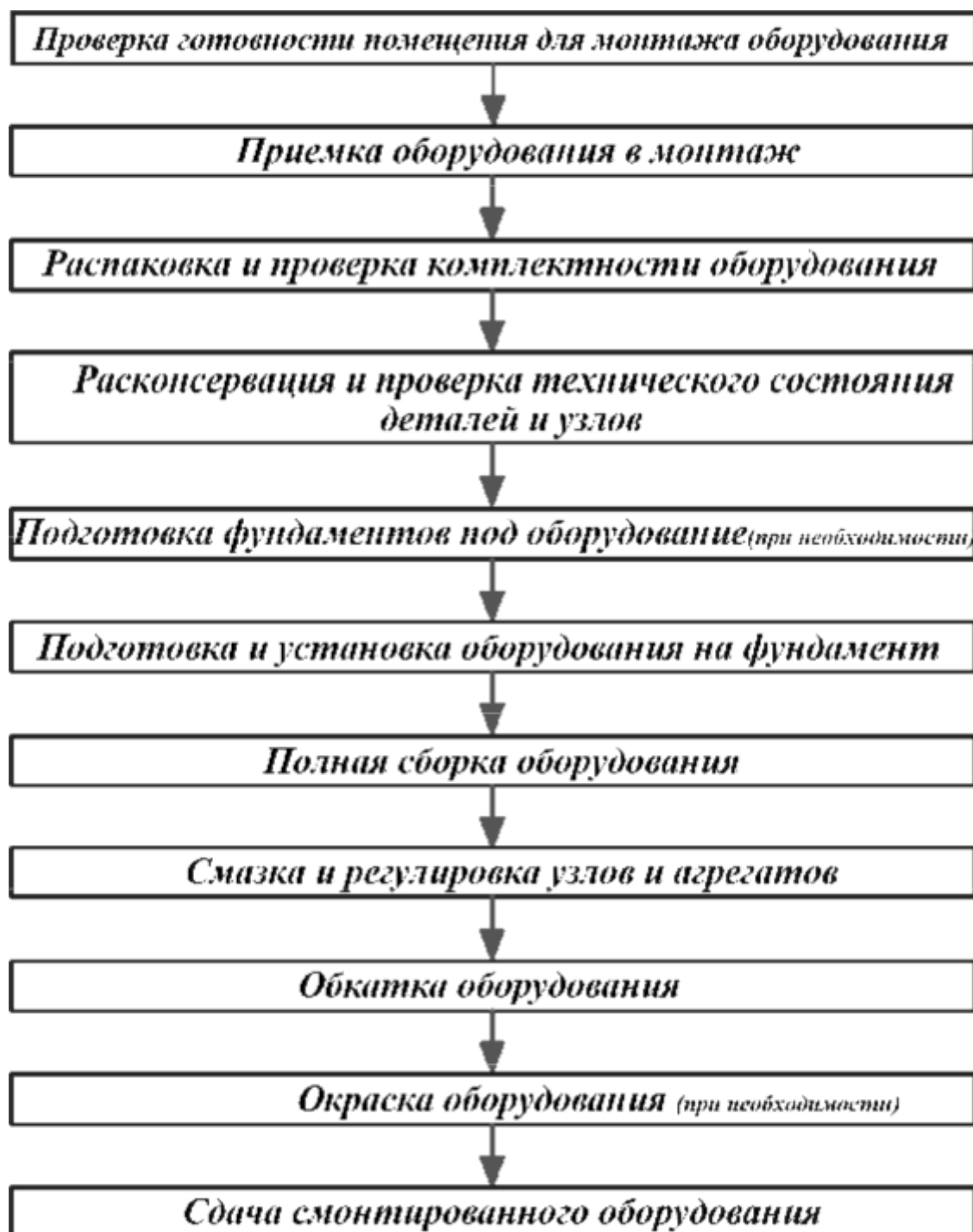
Рисунок 2.1 Примерная схема технологического процесса монтажа машин и оборудования
