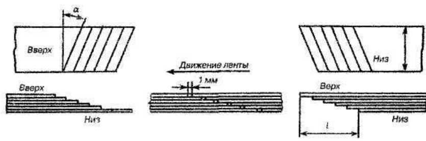
Рисунок 2.6 – Схема подготовки ленты к вулканизации
