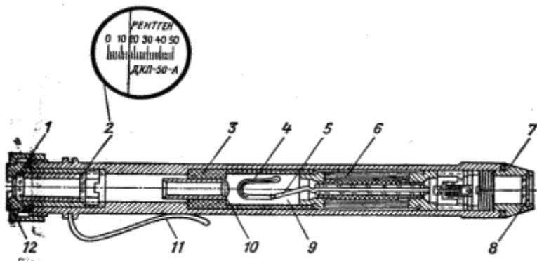
1 – окуляр; 2 – шкала; 3 – дюралевый цилиндрический корпус; 4 – подвижная платинированная нить; 5 – внутренний электрод (алюминиевый стержень); 6 – конденсатор; 7 – защитная оправа; 8 – защитное стекло; 9 – ионизационная камера; 10 – объектив; 11 – держатель; 12 – фасонная гайка
