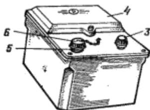
1 – зарядное устройство ЗД-5; 2 – индивидуальные дозиметры ДКП-50-А; 3 – ручка потенциометра; 4 – крышка отсека питания; 5 – зарядное гнездо; 6 – колпачок
