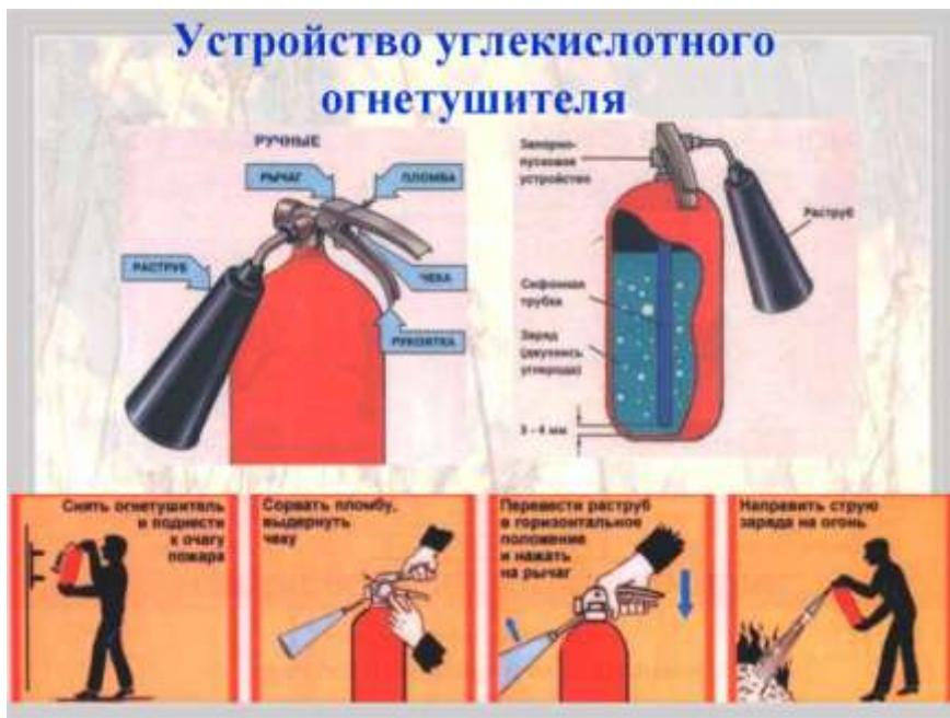
рис.2 Углекислотный огнетушитель
