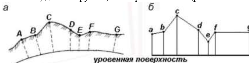
Рисунок 3.2. Вертикальный разрез (а) и профиль (б) местности
