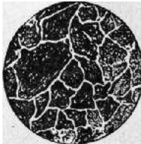
Рис.5 Микроструктура заэвтектоидной стали
