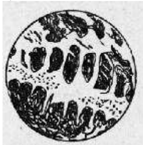
Рис. 7 Структура доэвтектического чугуна
