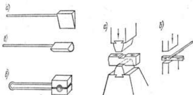
Рис.4. Схема свободной ковки: а-топор; б-раскатка; в-обжимка
