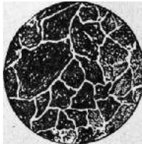
Рис.5 Микроструктура заэвтектоидной стали
