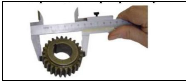
Рис.47 Определение диаметра вершин зубьев колеса
