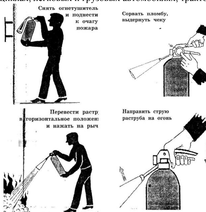
Рис. 3. Приведение в действие ручного углекислого огнетушителя.
