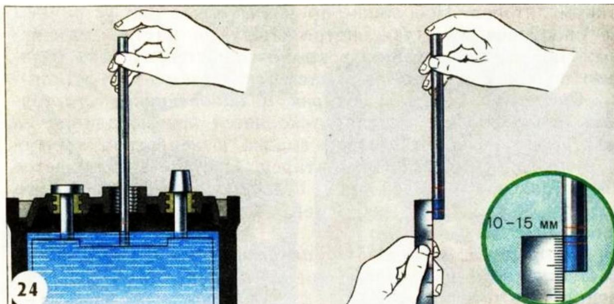
Рисунок 2 Измерение уровня электролита
