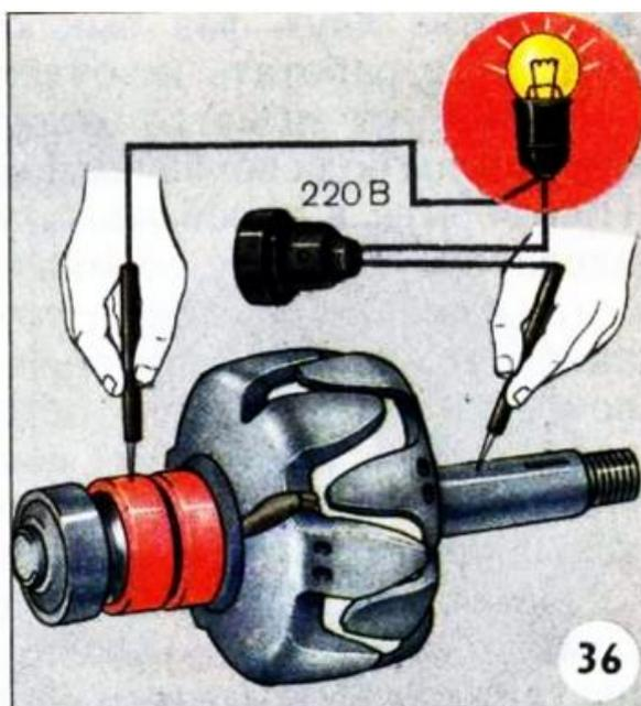
Рисунок 11 Проверка обмотки возбуждения на замыкание с корпусом
