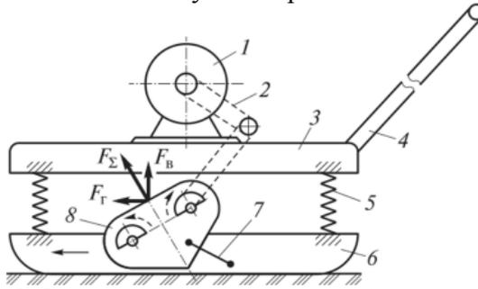
Рис. 3 Самопередвигающаяся виброплита
