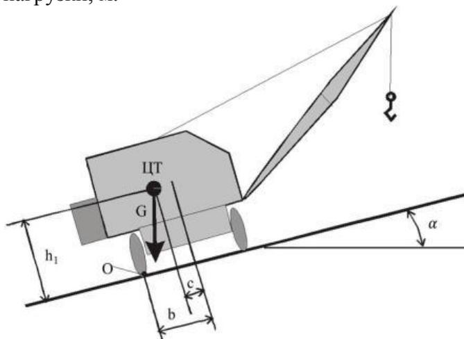
Рисунок 7. Расчетная схема собственной устойчивости самоходного крана
