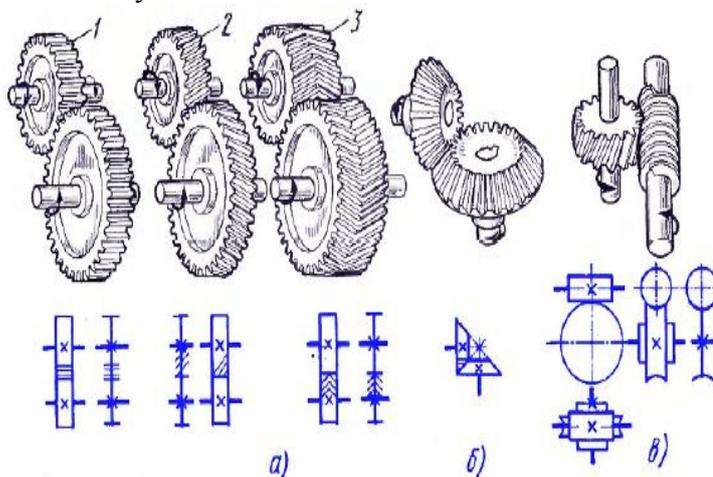
Рис. 9. Передачи автомобильных кранов и их обозначение на схемах:
