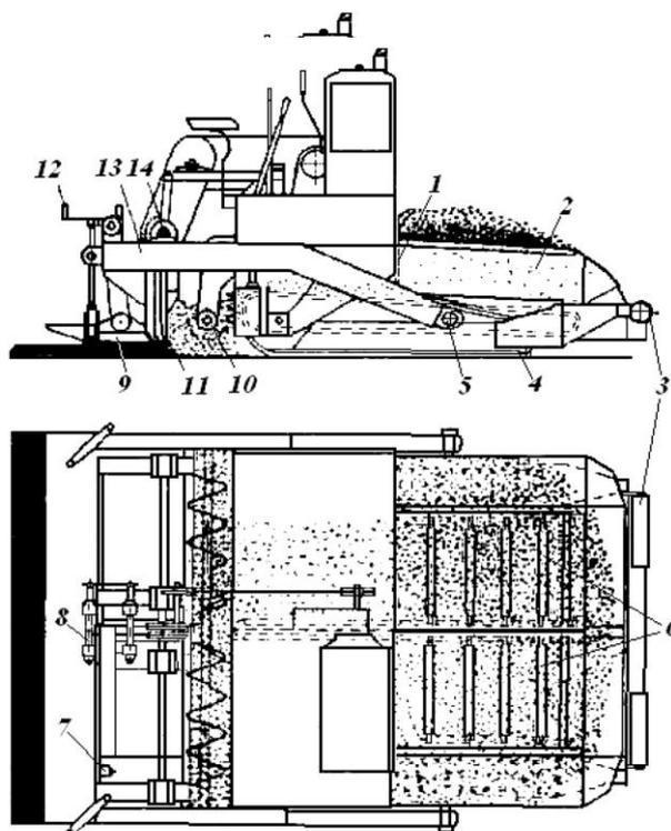
1 - шибберные заслонки; 2 - бункер; 3 - буферные ролики; 4 - гусеничный ход; 5 - шаровой шарнир; 6 - пластинчатые питатели; 7 - горелка; 8 - винты регулирования профиля; 9 - выглаживающая плита; 10 - распределяющие шнеки; 11 - трамбуемый брус; 12 - винты регулировки толщины слоя; 13 - брусья; 14 - эксцентриковый механизм трамбуемого бруса
