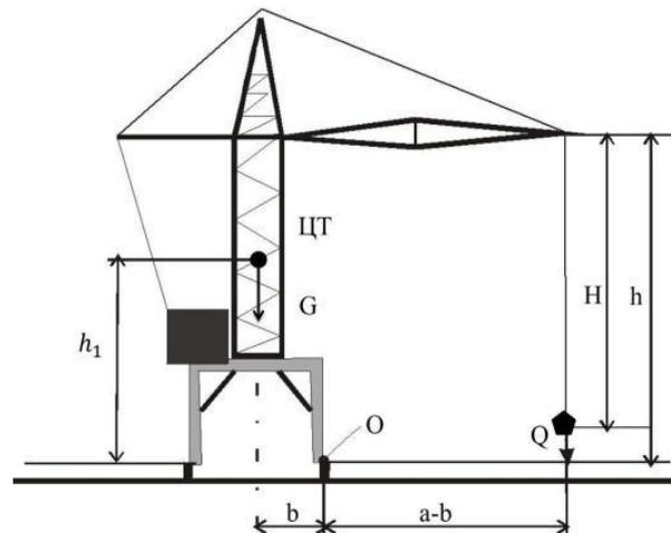
Рисунок 6. Расчетная схема грузовой устойчивости башенного крана
