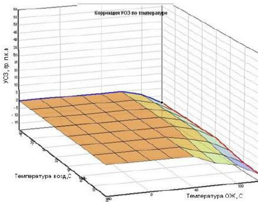
Рисунок 5. График зависимости УОЗ от температуры ТВС
