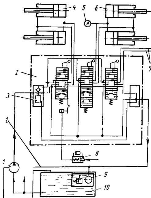
Рисунок 5 – Гидросистема рабочего оборудования погрузчика ТО-18:
