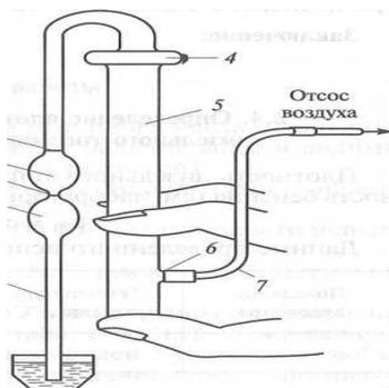
Рис. 6 Заполнение дизельным топливом вискозиметра Пинкевича 1 —узкое колено; 2, 3, 4 — расширительные емкости; 5 — широкое колено; 6 — полый отросток; 7 — резиновая трубка; А, Б — метки
