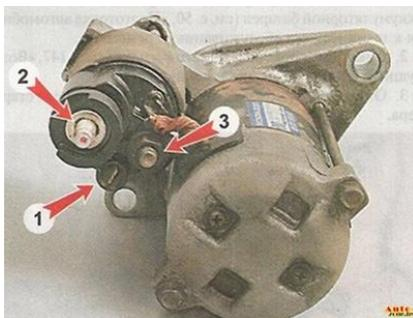
4.2. Подсоединяем второй провод к контактному болту 2 тягового реле. Используя отвертку или другой подходящий металлический предмет, замыкаем между собой вывод 1 и контактный болт тягового реле. Если раздался громкий щелчок и якорь стартера начал вращаться, тяговое реле исправно.
