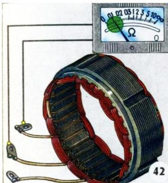
Рисунок 17 Измерение сопротивления фаз обмотки статора омметром
