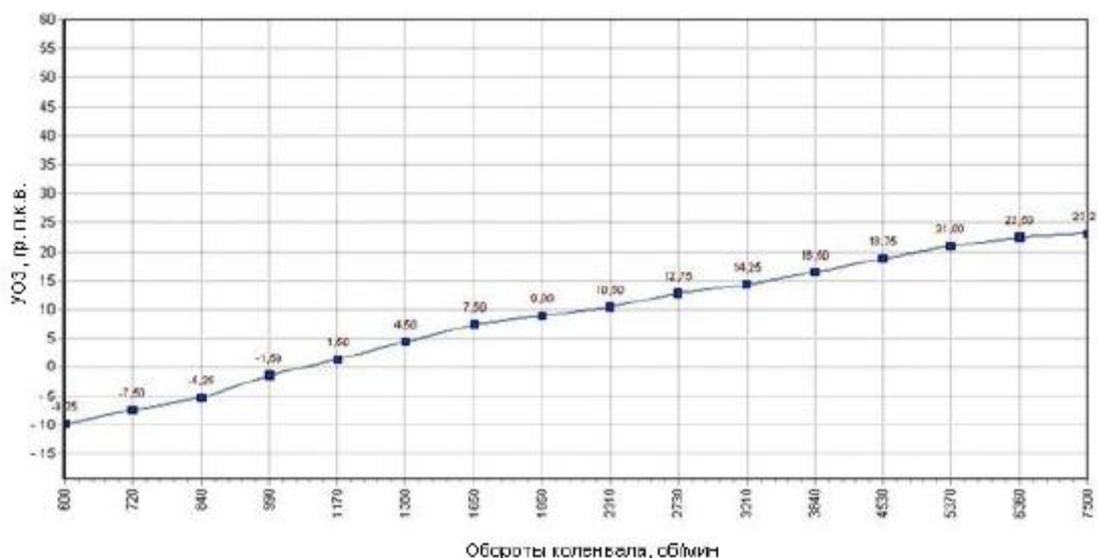
Рисунок 6. График зависимости УОЗ от нагрузки на двигатель
