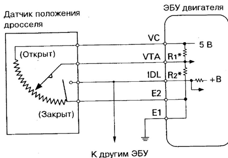
Рисунок 5. Схема включения датчика положения дроссельной заслонки.
