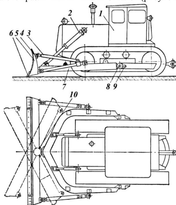
1 - трактор; 2 - гидроцилиндр; 3 - толкатель; 4 - козырек; 5 - отвал; 6 - нож; 7 - универсальная рама; 8 - опорный шарнир; 9 - опора; 10 - шаровое гнездо
