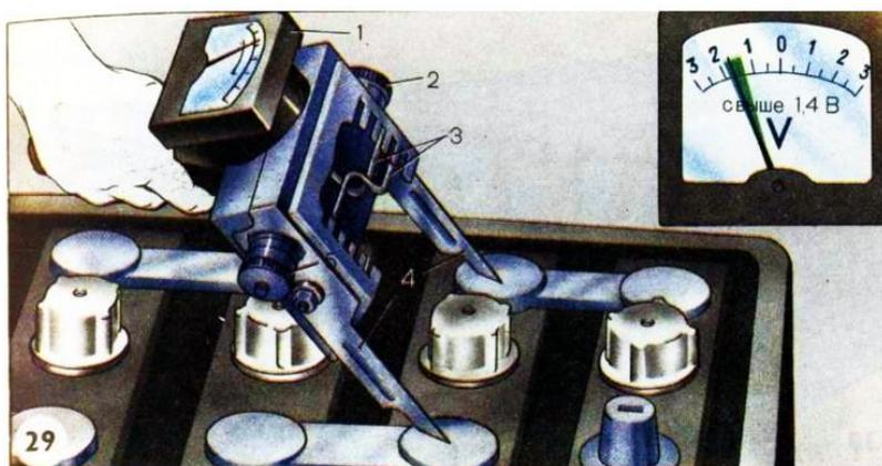
Рисунок 6 Измерение напряжения аккумулятора под нагрузкой пробником Э108
