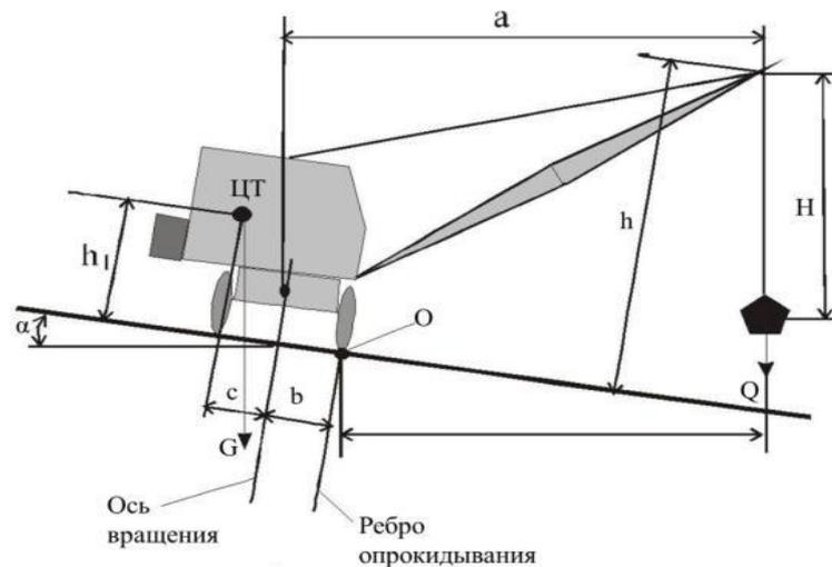
Рисунок 5. Расчетная схема грузовой устойчивости крана с грузом
