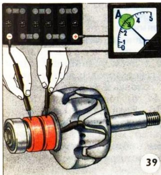
Рисунок 14 Измерение силы тока в цепи обмотки возбуждения
