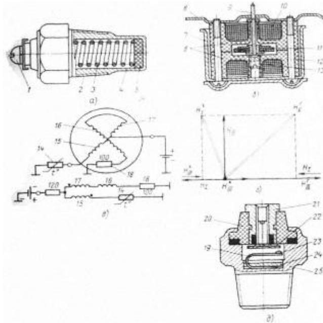
Рисунок 1. Датчик температуры: а) датчик ТМ - 100 с терморезистором;
