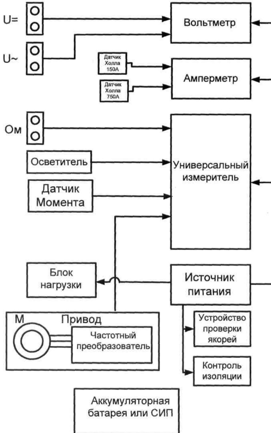
Рисунок 7. Схема электрическая функциональная стенда
