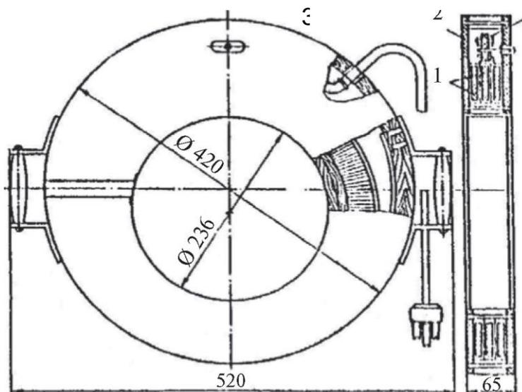
Рис. 5. Дефектоскоп ДГЭ:
