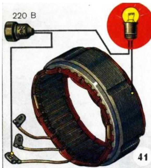
Рисунок 16 Проверка обмотки статора на замыкание с корпусом
