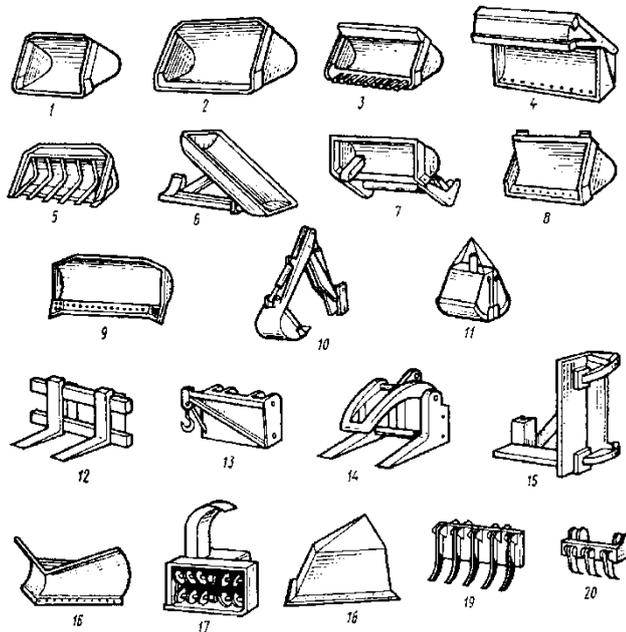
Рисунок 4 – Сменное и навесное оборудование одноковшовых погрузчиков:
