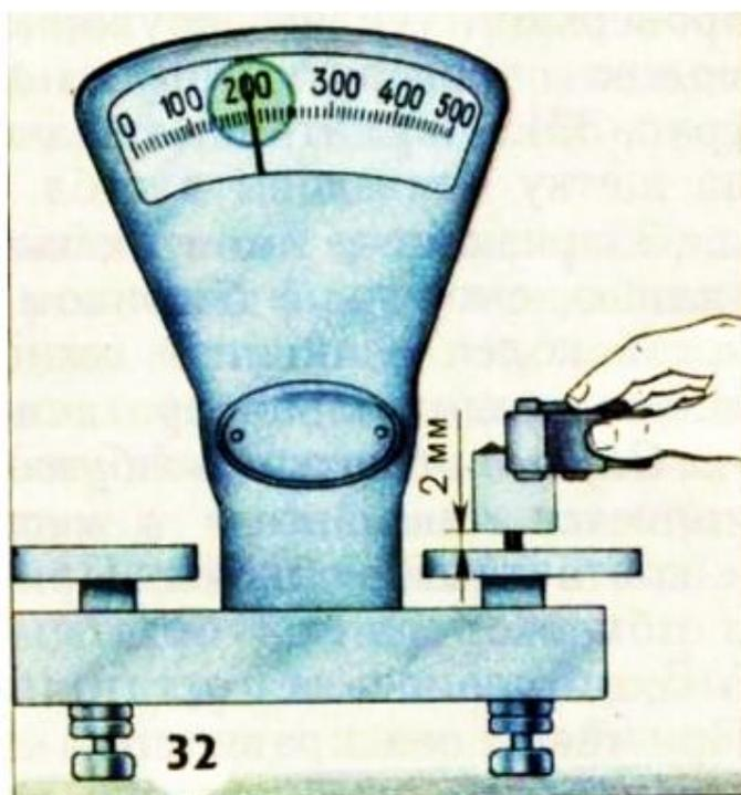
Рисунок 8. Проверка пружин щеток генератора на весах
