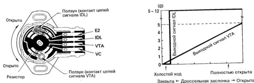
Рисунок 4. (а) Конструкция датчика положения дроссельной заслонки;
