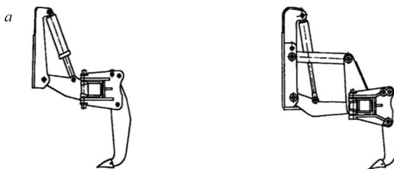
Рисунок 1.7 - Схемы устройства навесных рыхлителей:
