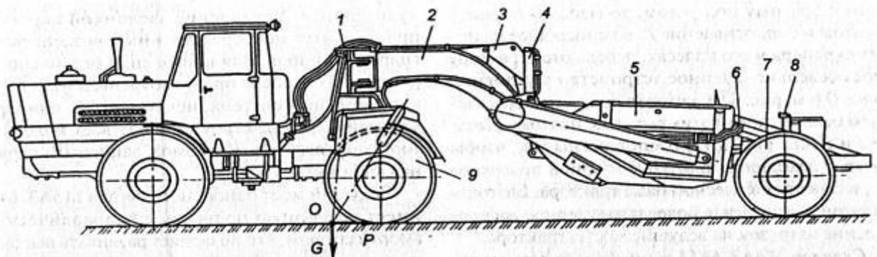
Рис. 3. Схема полуприцепного скрепера ДЗ-87-1:
