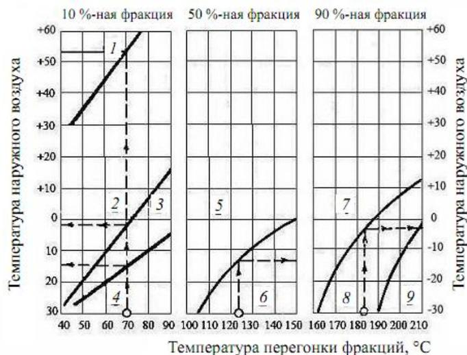
Рис. 4. Номограмма для эксплуатационной оценки карбюраторных топлив: области: 1 – возможного образования паровых пробок; 2 – легкого пуска двигателя; 3 – затрудненного пуска двигателя; 4 – практически невозможного пуска двигателя; 5 – хорошей приемистости и неустойчивой работы двигателя; 6 – плохой приемистости и неустойчивой работы двигателя; 7 – незначительного разжижения масла в картере; 8 – заметного разжижения масла; 9 – интенсивного разжижения масла в картере.
