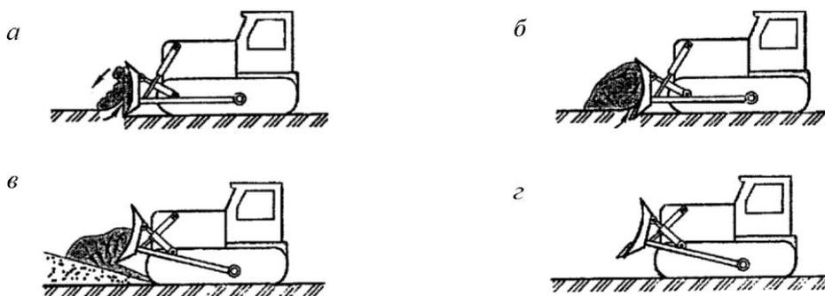
а - резание; б - транспортирование с подрезанием; в - отсыпка; г - возврат назад (холостой ход)
