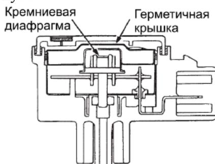
Рисунок 6. Конструкция датчика абсолютного давления (MAP)
