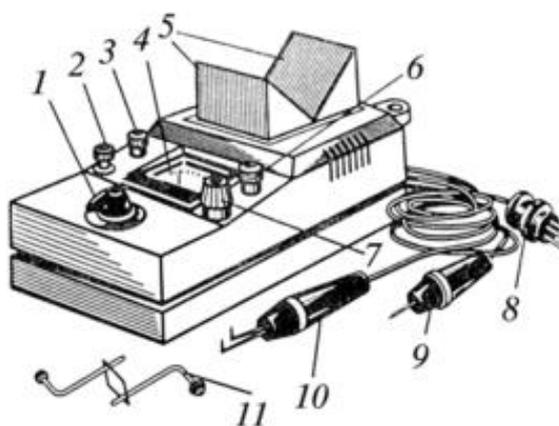
***Прибор типа Э236 для проверки якорей стартеров и роторов генераторов:***
