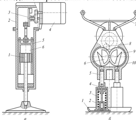
Рис. 2. Ручные трамбовки
