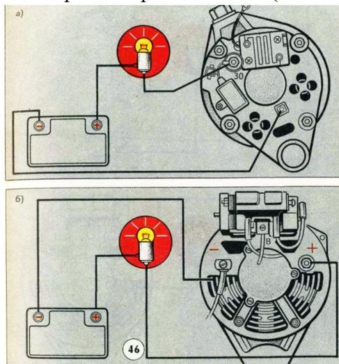
Рисунок 20 Проверка на автомобиле диодов прямой проводимости на пробой генератора с блоками БПВ (а) и ВБГ (б)
