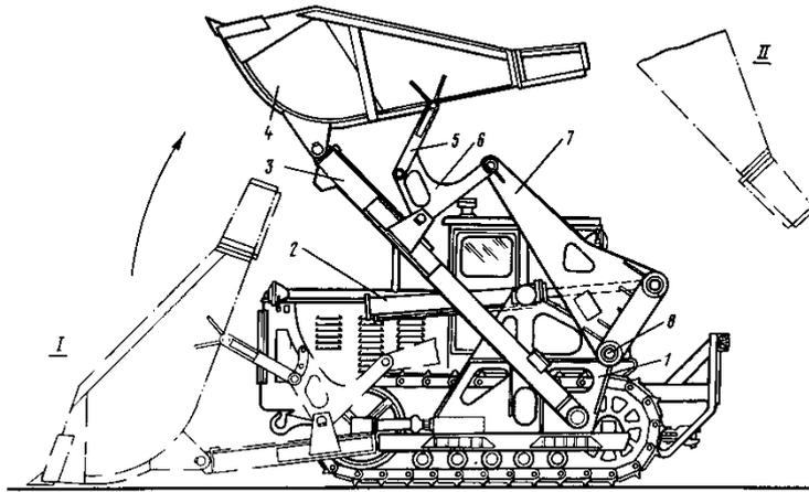
Рисунок 3 – Одноковшовый погрузчик Т-157М перекидного типа
