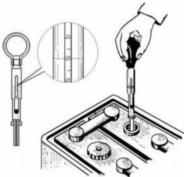
Конструктивно ареометр для аккумулятора имеет вид стеклянного поплавка, с расположенной внутри шкалой измерения. Во многих моделях он помещен в прозрачную колбу (пипетку) из стекла или пластика.
