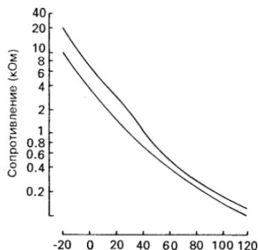
Рисунок 3. Зависимость сопротивления датчика Toyota от температуры.
