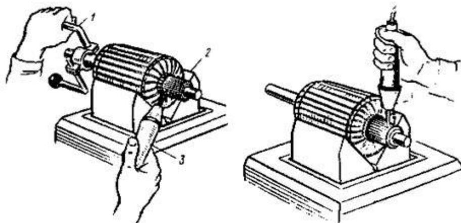
Наиболее эффективно межвитковое замыкание определяют с помощью стальной пластины. Для этого переключатель *I* устанавливают в положение «II». Приспособлением *II* поворачивают якорь вокруг оси в полюсах *5* прибора, одновременно стальной пластиной касаясь поверхности сердечника якоря (рис. 15). При наличии короткого замыкания в какой-либо секции обмотки пластина будет вибрировать над пазами, в которые уложена эта секция за счет наводимого в ней внешним полем тока.
