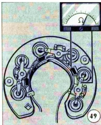
Рисунок 24 Проверка дополнительных диодов выпрямительного блока БПВ генератора 37.3701
