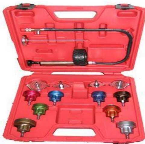
Рисунок 1 - Тестер для проверки герметичности системы охлаждения SMC-112
