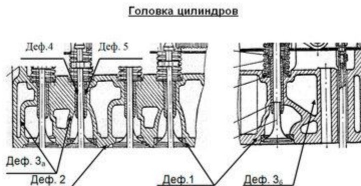
Рис.1 Схема основных дефектов головки цилиндров.
