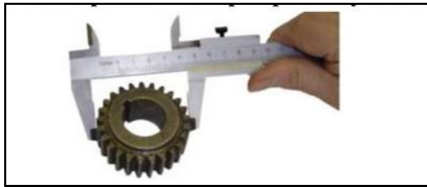
Рис.47 Определение диаметра вершин зубьев колеса
