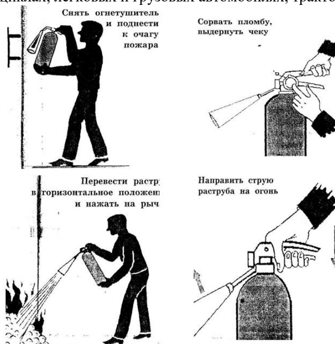
Рис. 3. Приведение в действие ручного углекислого огнетушителя.
