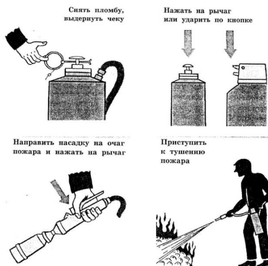
Рис.1. Приведение в действие воздушно-пенного огнетушителя.
