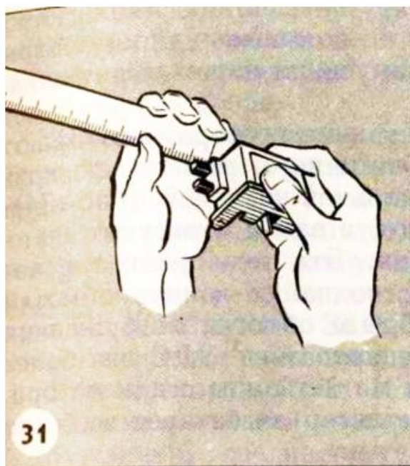
Рисунок 7. Измерение высоты щетки
