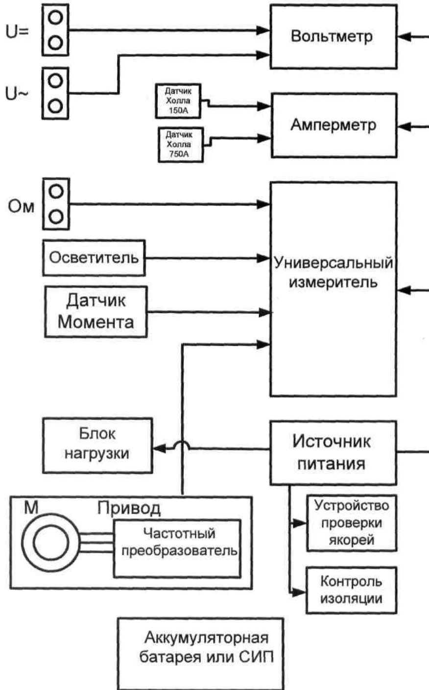
Рисунок 7. Схема электрическая функциональная стенда
