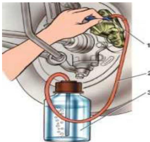
Рис. 2. Удаление воздуха из гидропривода тормозов: 1 - штуцер для прокачки; 2 - шланг; 3 - сосуд с жидкостью
