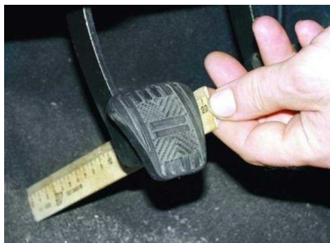
Рисунок 1- Проверка свободного хода педали сцепления
