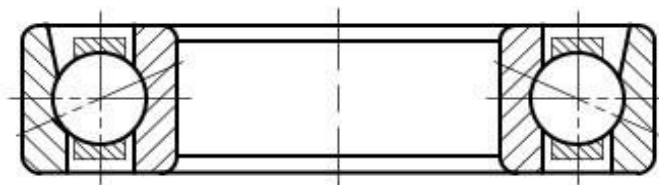
Рис. 3. Схема радиально - упорного подшипника.
