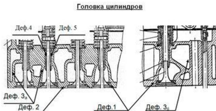
Рис.1 Схема основных дефектов головки цилиндров.
