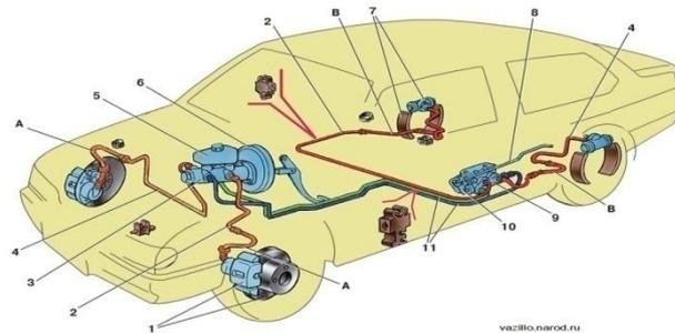
Необходимо вспомнить назначение, устройство и прядок работы тормозной системы автомобиля ВАЗ 2110.
