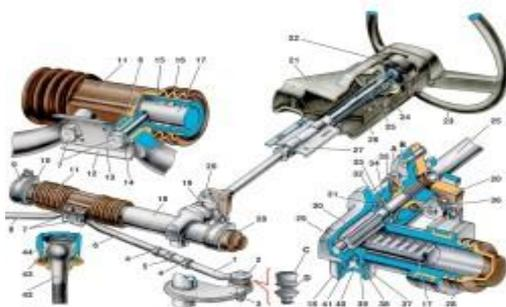
Необходимо вспомнить назначение, устройство и прядок работы рулевого управления автомобиля ВАЗ 2110.
