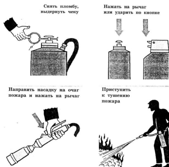
Рис.1. Приведение в действие воздушно-пенного огнетушителя.
