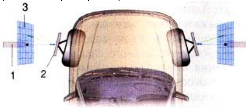
Рисунок 3 - Оптический стенд для измерения углов установки колес: 1 – излучатели; 2 – зеркала; 3 – размеченные экраны
