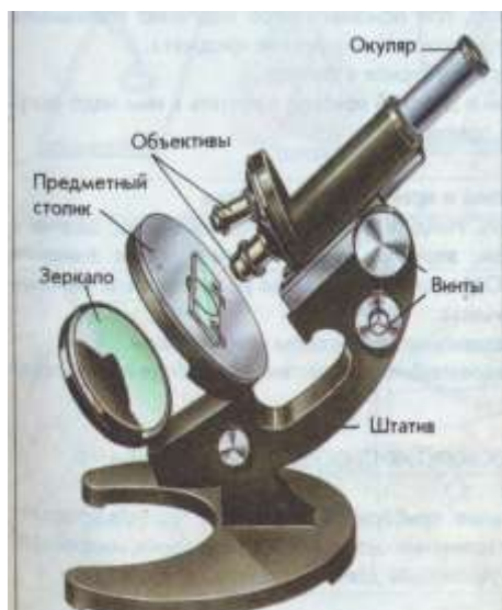
Рис. 1. Строение светового микроскопа
