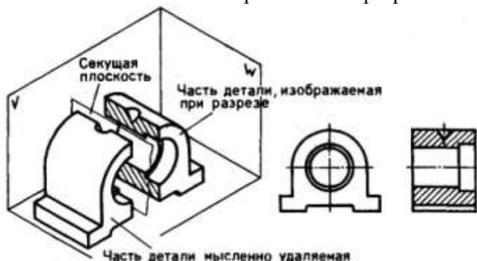
Рис. 54. Профильный разрез
