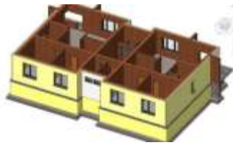
Рис. 7. Модель со скрытым внешним слоем кирпичной кладки
