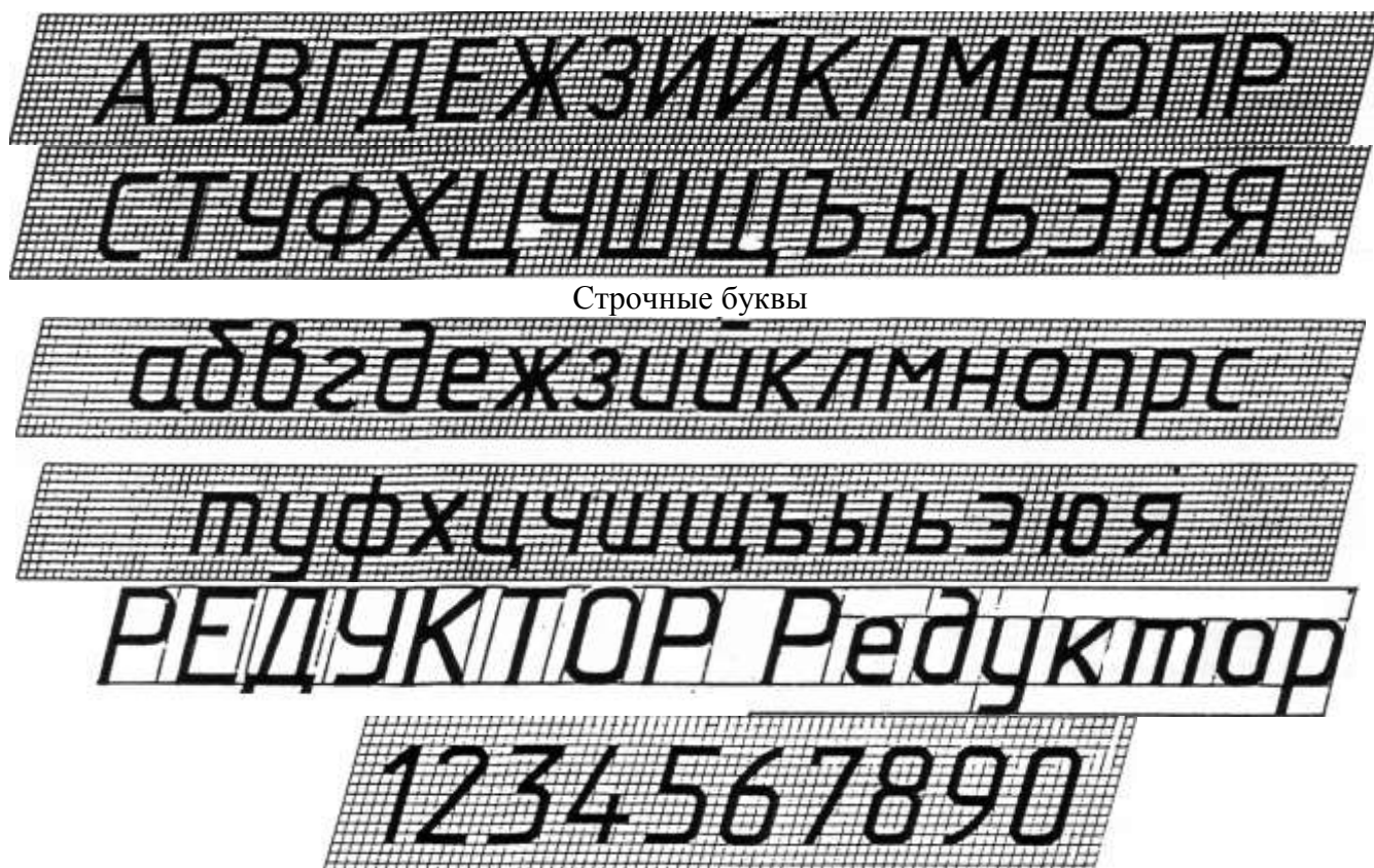
Рисунок 2 - Шрифт типа Б с наклоном. Прописные буквы
