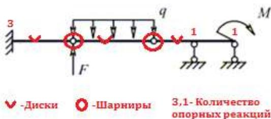
$W = 3 \cdot 3 - 2 \cdot 2 - 5 = 0$ , следовательно, система геометрически неизменяемая и статически определимая.
