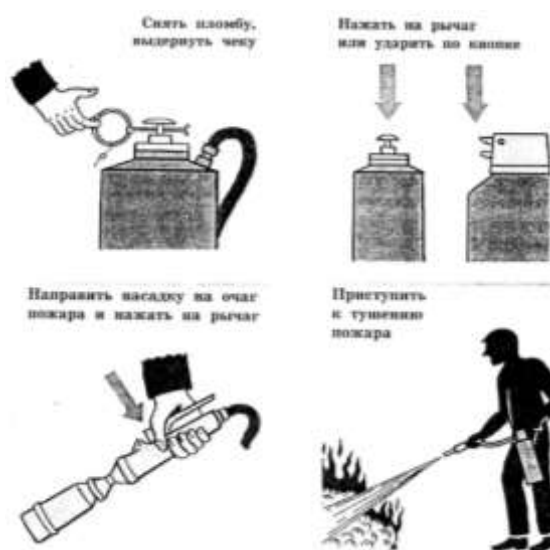
Рис.1. Приведение в действие воздушно-пенного огнетушителя.
