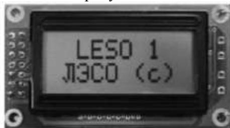
Рисунок 20 – Внешний вид жидкокристаллического индикатора
